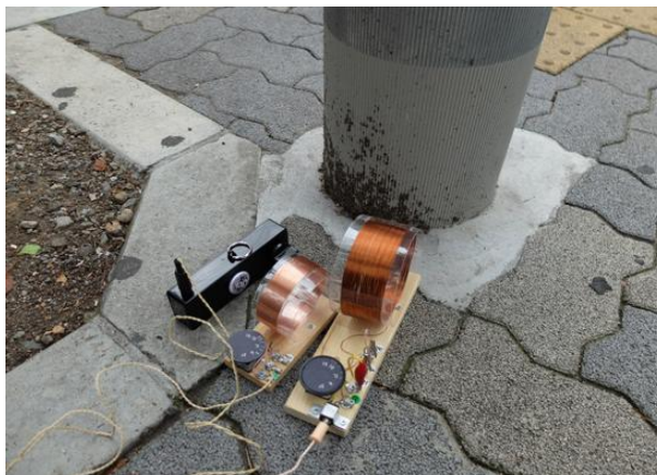
左から、探検隊プリセットラジオ、500ccペットボトルラジオ、1.5Lペットボトルラジオ (写真1)
