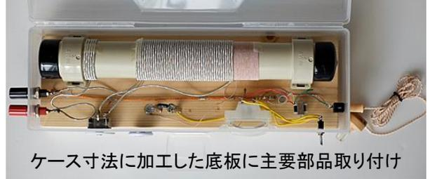
ケース寸法に加工した底板上に主要部品取り付け
