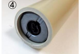
④ ③にビニールテープを適宜巻きパイプに挿入した際、ガタがないようにします。
