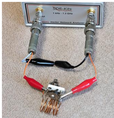
VNWA3で、トリマ中間点の同調周波数と可変周波数範囲を測定 ※想定周波数範囲でミヌムシクリップ使用状態でスルーキャリブレーションを実施
